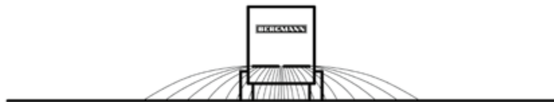
Wynik rozrzuconia ze standardowym adapterem rozrzucającym
