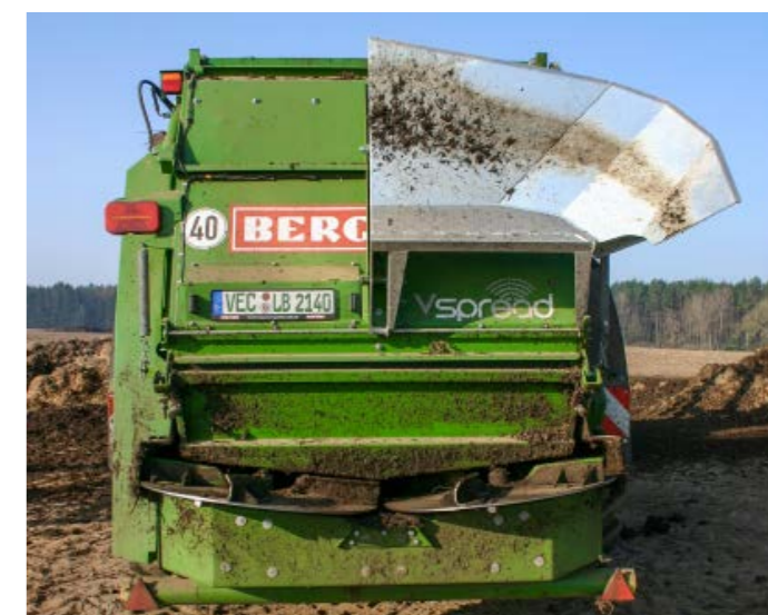
Adapter rozrzucający V-Spread o średnicy talerzy rozrzucających 1.000 mm z czterema łopatkami rozrzucającymi.
