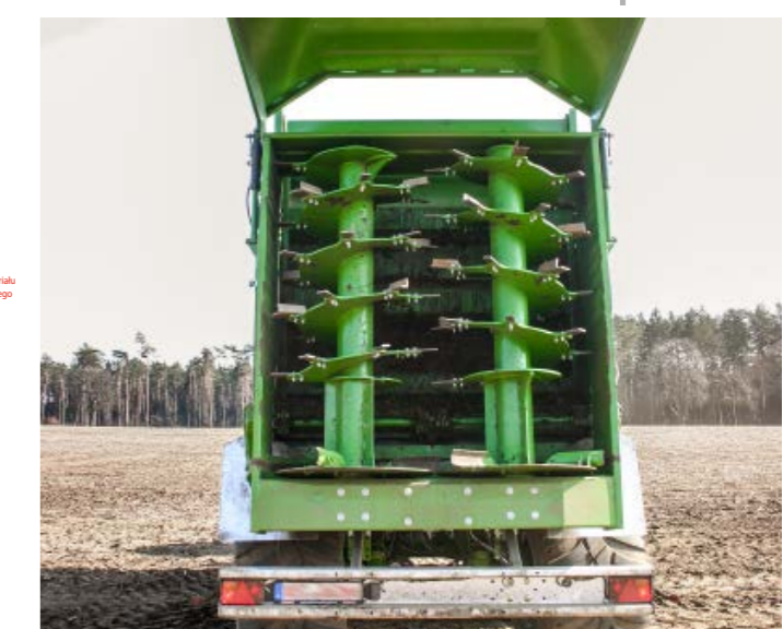
Adapter rozrzucający 2-Spread z dwoma pionowymi walcami.
